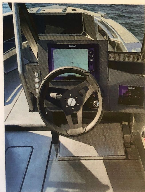
Förarplatsen är mycket ändamålsenligt utformad, och den svartkolfibermönstrade folien på instrumentpanelen minskar reflektinerna från aluminiumet.
